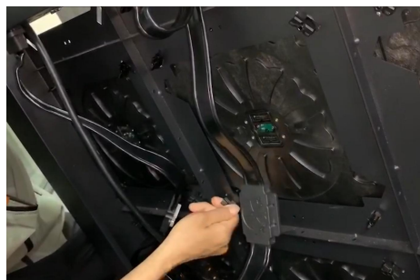
■ 将背面螺栓扭转至箱体栓口平齐
